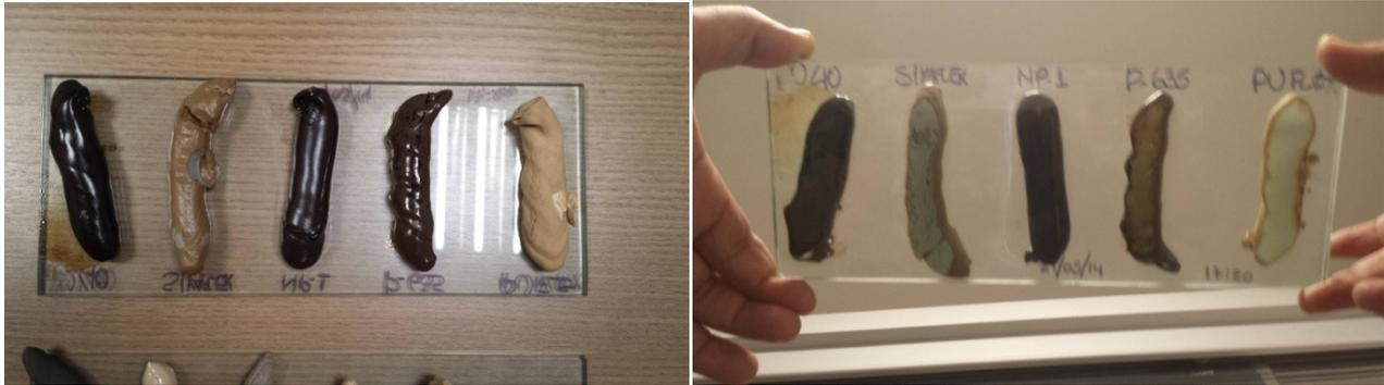
**PU40** - A amostra ficou totalmente rígida, provavelmente por obter um alto teor de cargas minerais. Obteve grande exsudação de óleo, solventes e plastificantes, e apresentou grande queima, provavelmente de compostos orgânicos, resultando numa cor escura, incluindo o seu interior.
